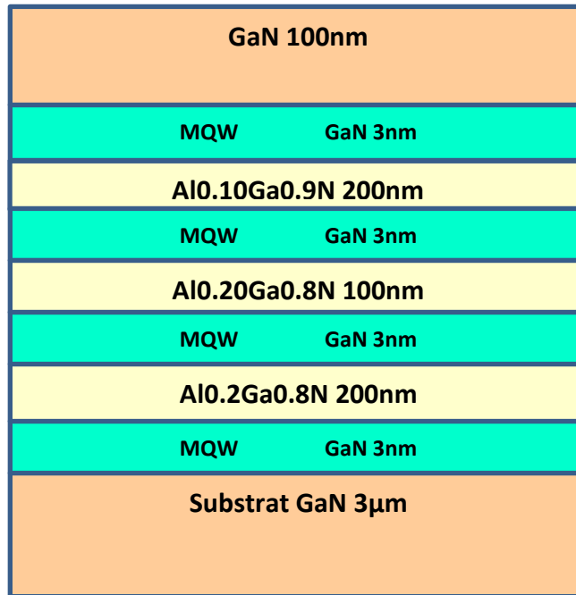
Figure III.5 : Coupe schématique de la structure LED AlGaN/GaN à 4 puits quantiques.
