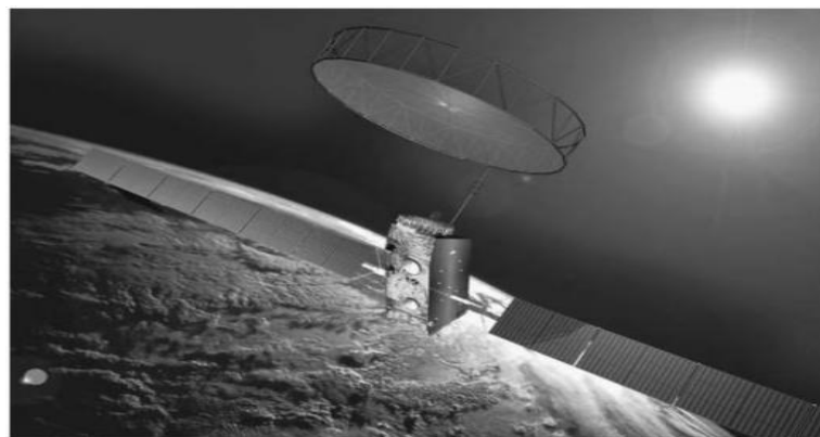
Figure I-9 : Antenne à réflecteur (AstroMesh) d'INMARSAT-4[I.7].
