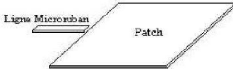
Figure 14 Alimentation du patch rectangulaire par couplage. [10]
