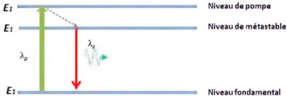
Figure II.7 : les propriétés d'une fibre dopée erbium.
