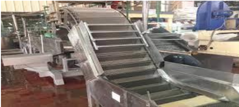
Figure 1: Elévateur du deuxième lavage (Essabti, 2015).
