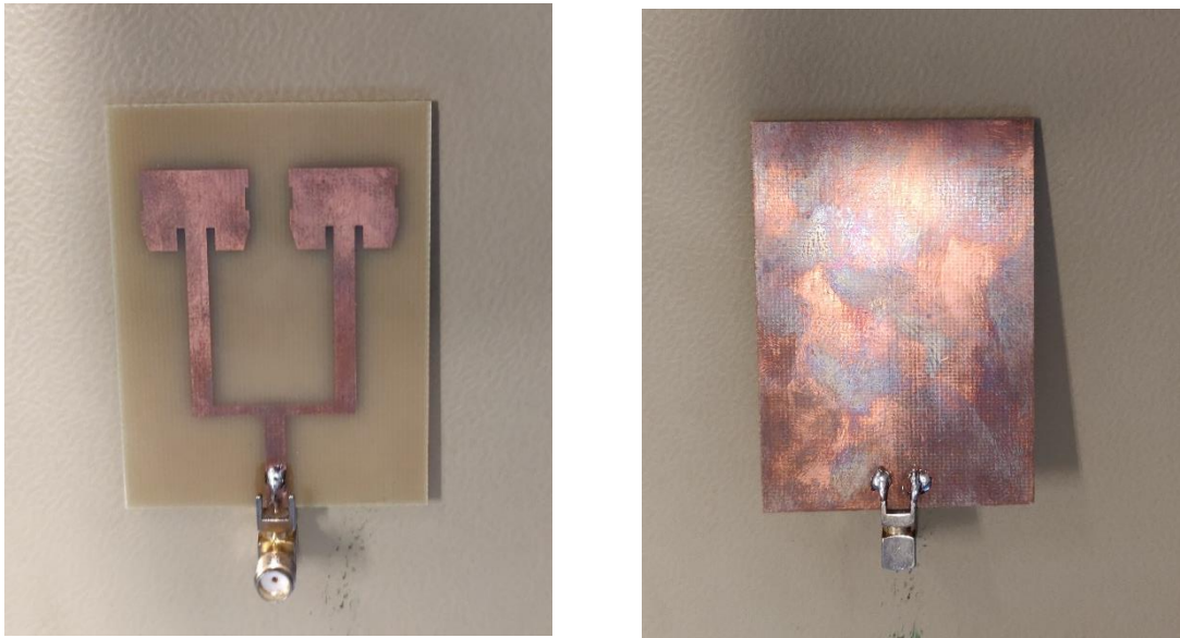
Figure III.46: réseaux d'antenne (2×1) à réaliser (face supérieure et inférieure)
