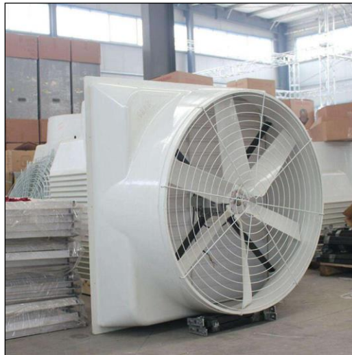
Figure 3.3. Ventilateur d'extraction d'air.
