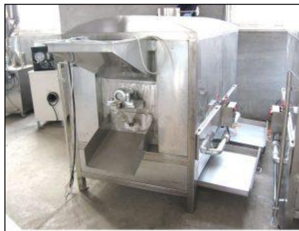
Figure 2.9. Torréfacteur de la pulpe de caroube.
