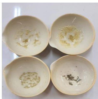
Figure 15 : Résultat visuel de la calcination des différents extraits de chitosane ( originale ).
