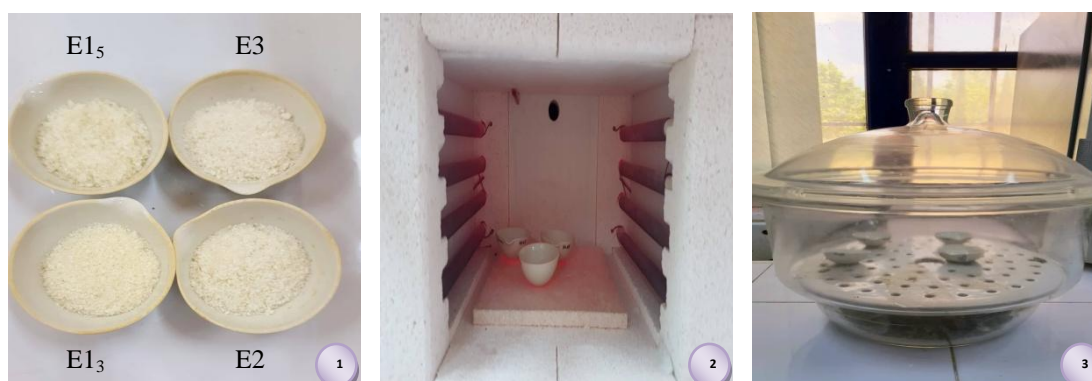
Figure 10 : Etapes de dosage de la teneur en cendres totales ( originales ).
