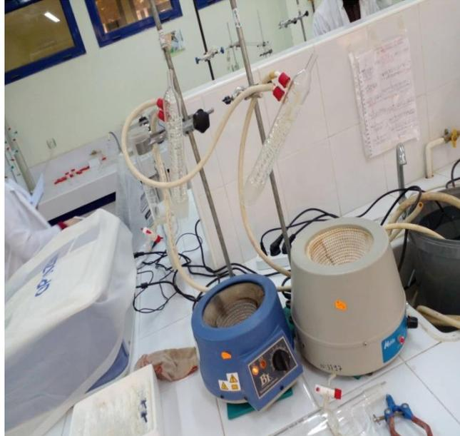
**Figure 11** : dispositif d'extraction des huiles fixes (méthode de soxhlet)
