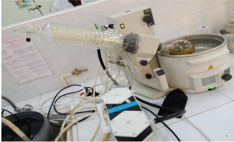
*Figure 12 : Photographie du Rotavapeur utilisé*
