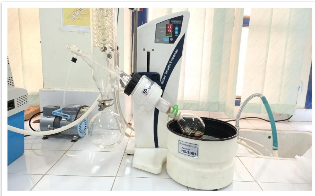
**Photo 5 :** Évaporation sous vide des phases par un évaporateur rotatif
