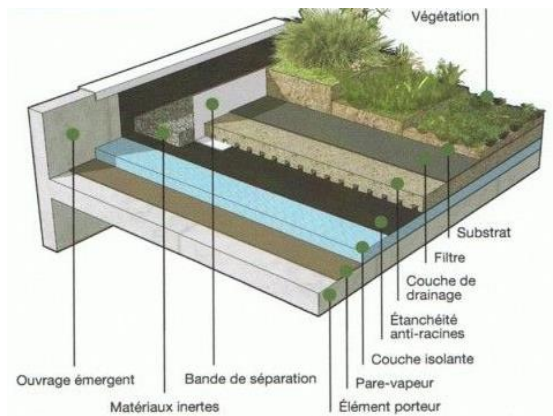
Figure 68 : la toiture végétalisée Source : http://www.cder.dz
