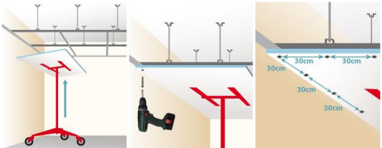
Figure -3-4 : la fixation d'un faux plafond.
