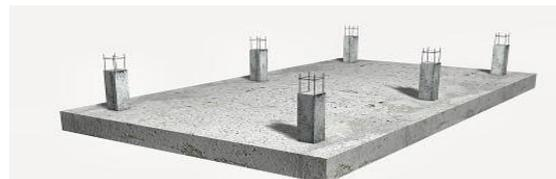
Figure 70 Radier Général en béton armé
