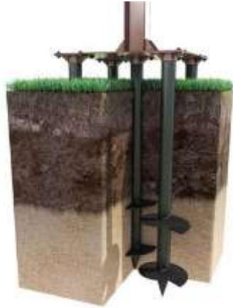
Figure 63: méthode de creusement d'un pieu
