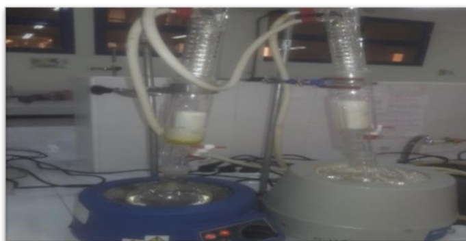
Figure 13: Une extraction soxhlet des pétales de crocus dans le solvant (hexane) (Photo prise au laboratoire).
