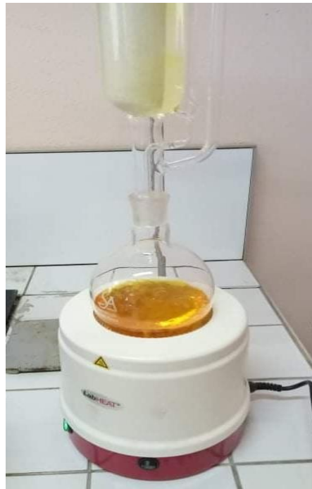
Figure 16 : Montage d'une extraction par soxhlet.
