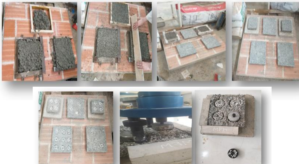
FIGURE 31 : LES ETAPES DE L'ESSAIE D'ADHERENCE
