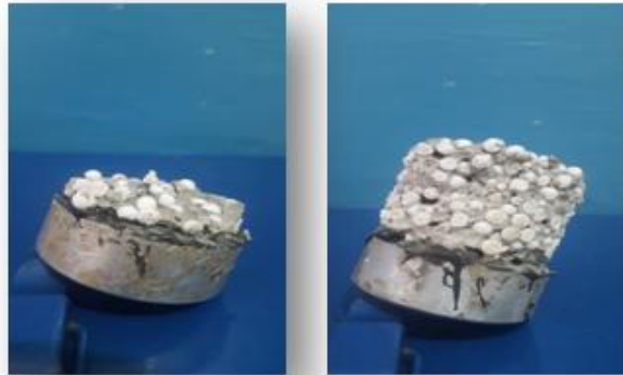
FIGURE 32: LES RESULTATS DE L'ESSAIE D'ADHERENCE
