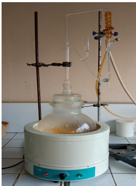
**Photo 4 : Dispositif d'extraction des huiles essentielles par hydrodistillation avec un appareil de type Clevenger**
