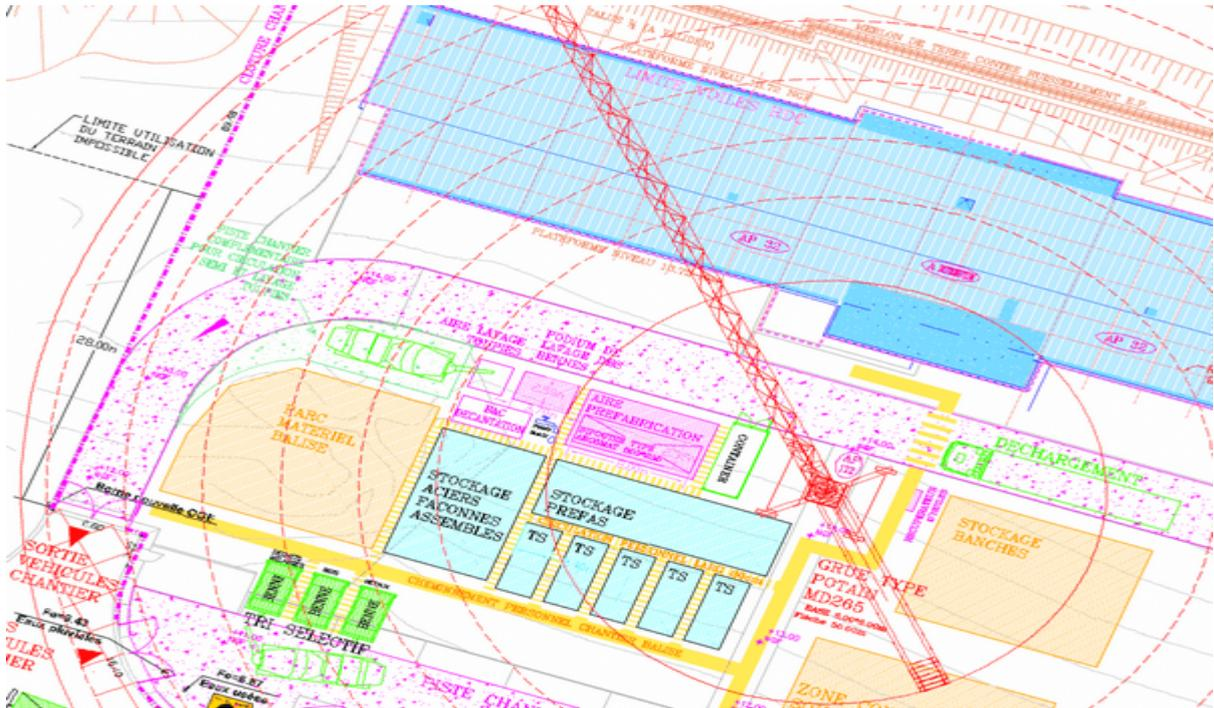
**Figure 25 : Plan d'installation de chantier [18]**
