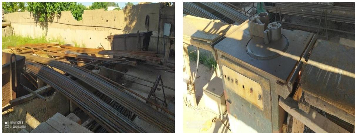
Figure 29 : Table de façonnage
