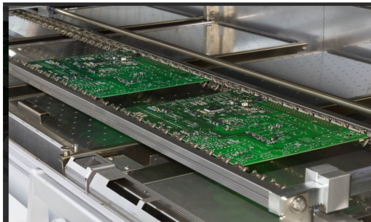
Figure I.8 Brasage par refusion [8].
