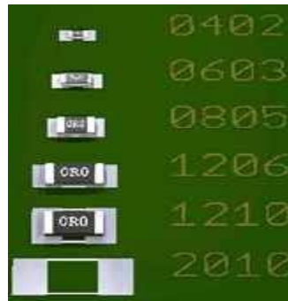
Figure I.5 : Type de boîtiers CMS pour les résistances [5].
