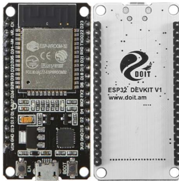
Figure II.3 : Structure d'ESP32 Module
