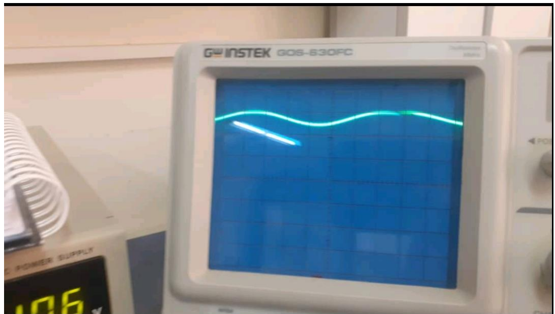
Figure III.18 : Le signal de sortie de filtre passe bas
