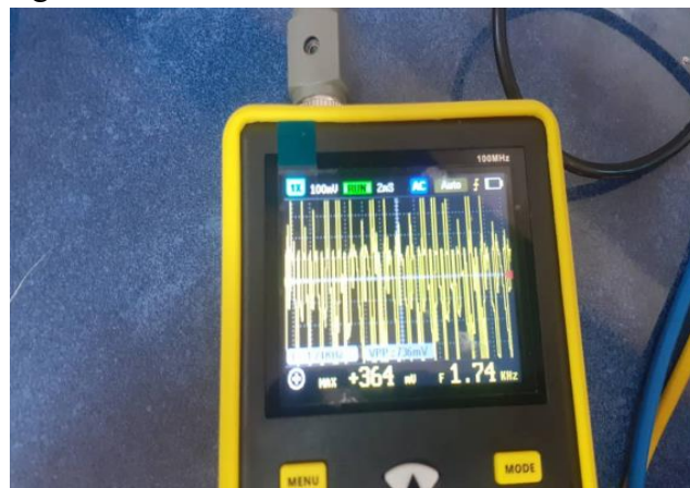
Figure III.13 : Signal à la sortie du démodulateur
