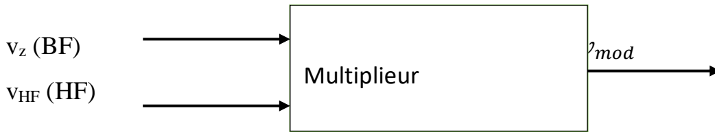
Figure II.11: Multiplieur pour la simulation de la modulation
