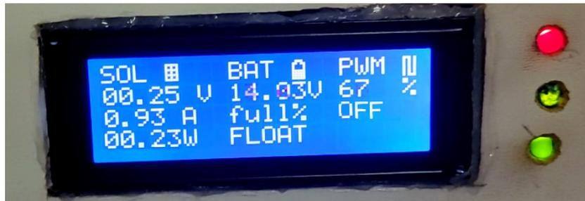
**Figure III. 23 Visualisation de résultat de réalisation durant le mode "OFF"**
