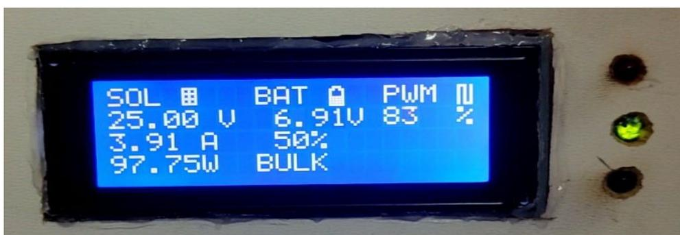
Figure III. 28 Visualisation de LCD dans le mode "BULK"
