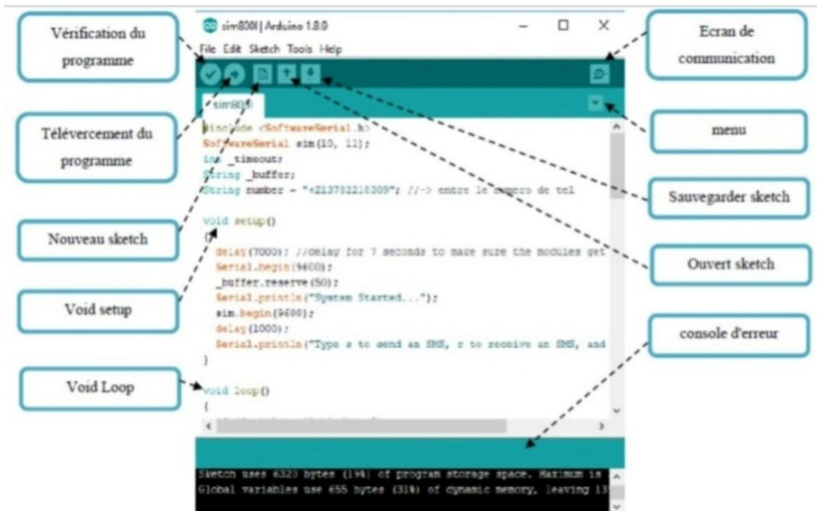
Figure II. 7 Structure générale de l'Arduino IDE
