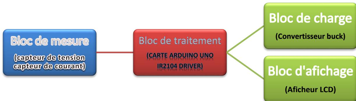
Figure III. 1 Les différents blocs qui consiste notre prototype.
