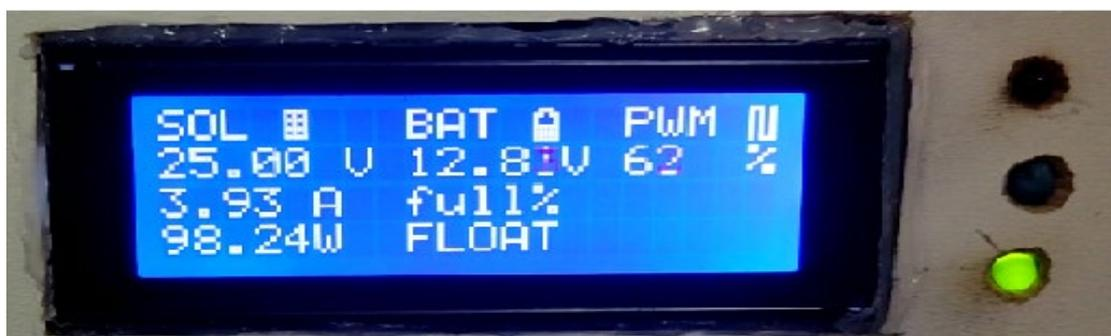
Figure III. 30 Visualisation de LCD dans le mode "FLOAT"
