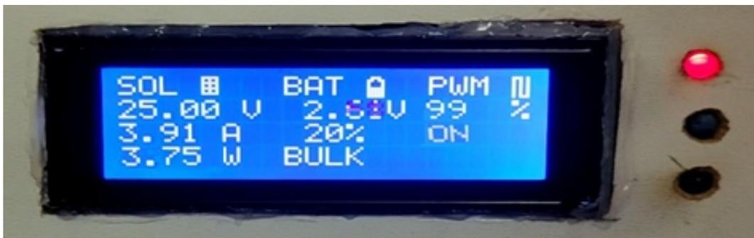
Figure III. 26 Visualisation de LCD dans le mode "ON"
