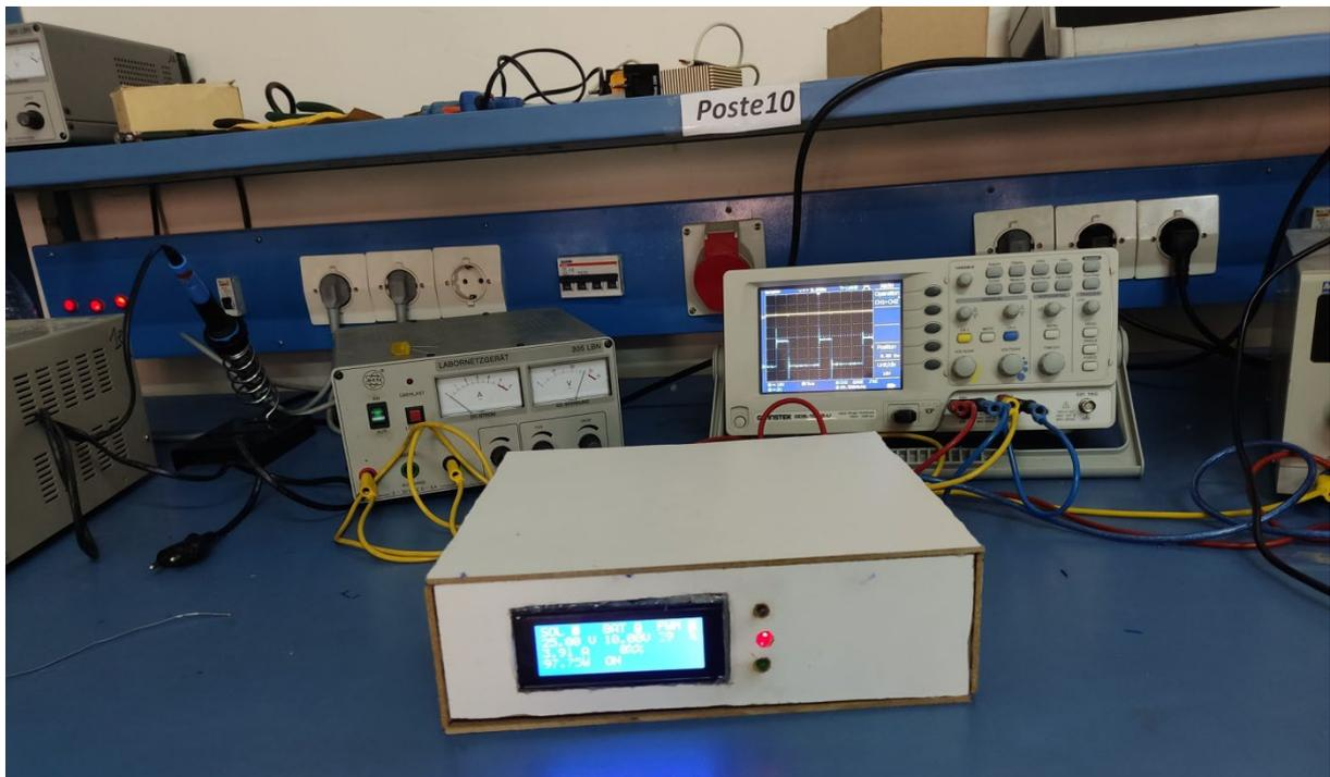
Figure III. 32 Prototype de contrôleur de charge solaire MPPT dans son boîtier
