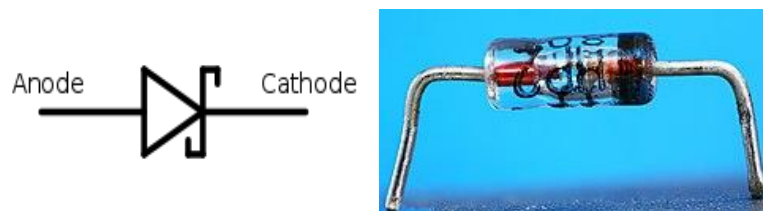
Figure II-3 : Image et symbole d'une diode Schottky
