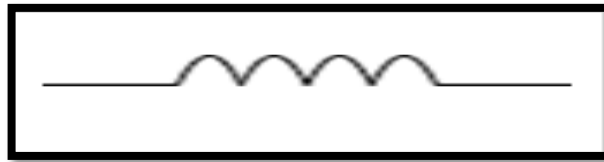
Figure II-18 : Représentation symbolique d'une bobine.
