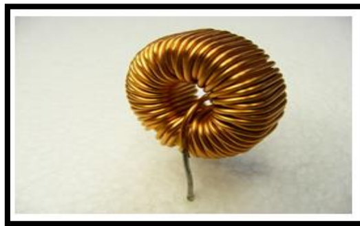
Figure II-17 : Une bobine torique - Un fil isolé est enroulé autour d'un noyau de ferrite
