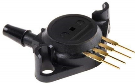
Figure 3.7 : Image et Brochage du capteur MPX2200AP
