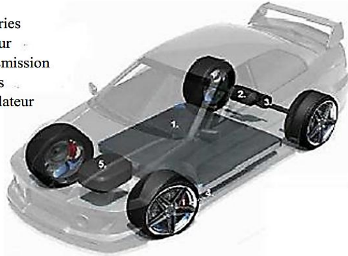
Figure I.1 Système de propulsion d'un véhicule électrique [13].
