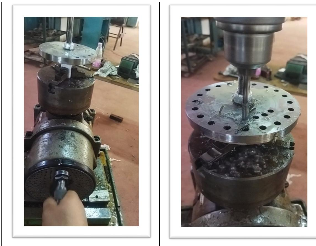
Figure 4.36: perçage du pièce 9 sur plateau diviseur
