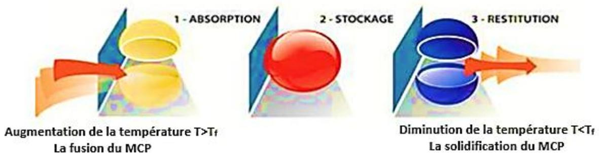
**Figure I.3** : principe de fonctionnement des matériaux à changement de phase.
