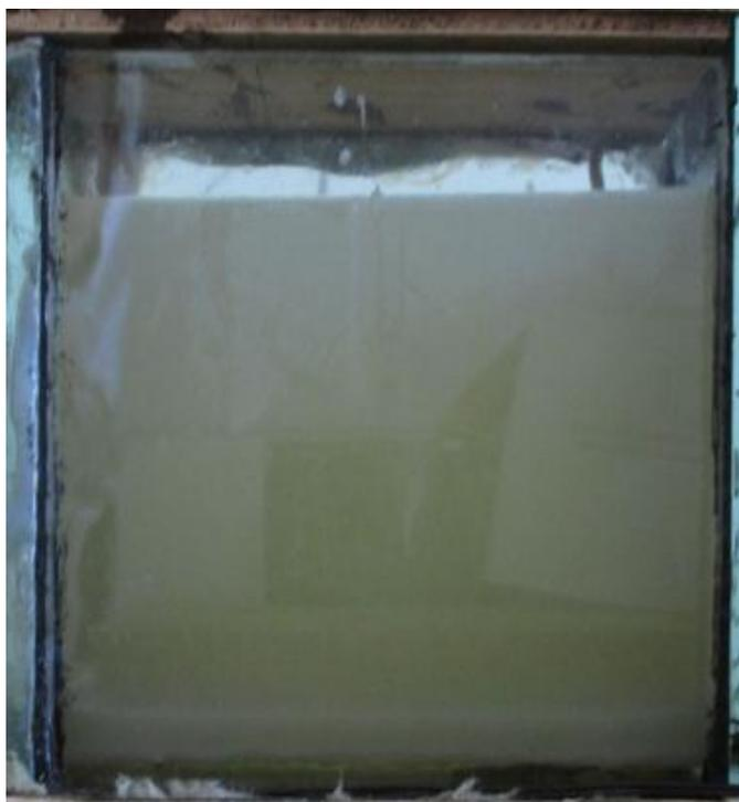
**Figure III.1** :Cavité remplie de la paraffine solide en présence d'un espace d'air
