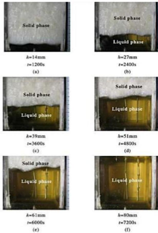
**Figure II.10 :** Evolution temporelle de la fusion du Tétracosane en maintenant la paroi inférieure à une température constante de  $T_w = 80 \text{ }^\circ\text{C}$ .
