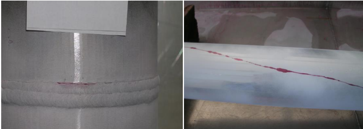
Figure II 19. Poudre magnétique de contrôle par magnétoscopie [12]
