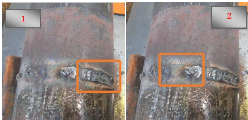
Figure III 9: 1) Manque de fusion, 2) Manque de pénétration
