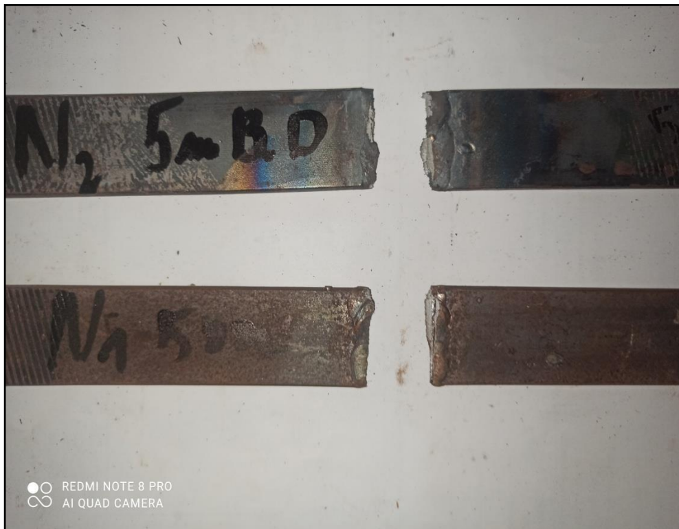
Figure (IV.07): éprouvettes 5mm soudé par déférente procédé après traction.
