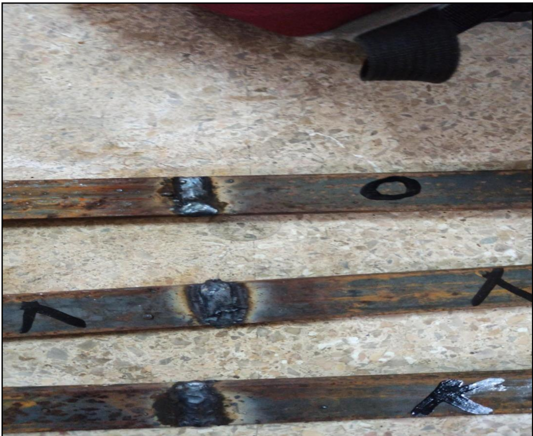
Figure (III.09) : des pièces soudées par électrode enrobée
