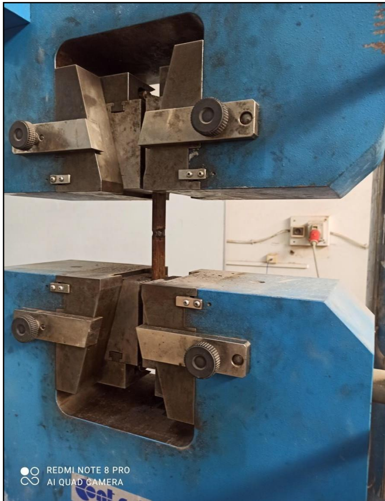
Figure (III.15) : l'éprouvette placée dans la machine.
