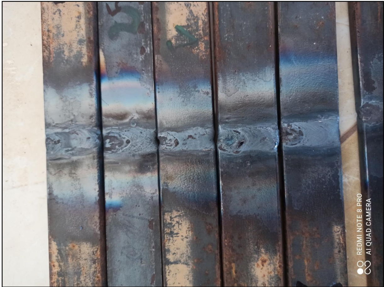
Figure (III.10) : photo des pièces soudées par TIG
