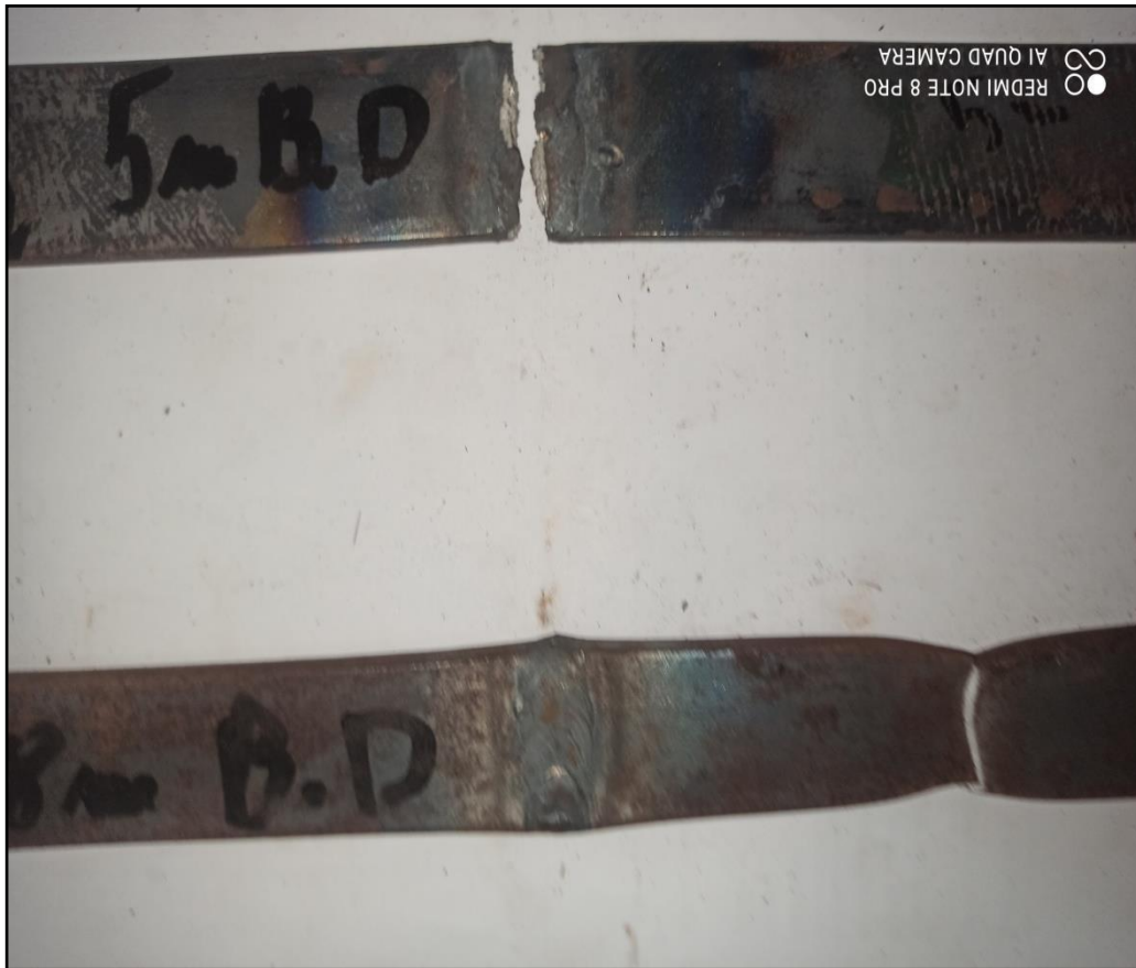
Figure (IV.05): Eprouvettes 5mm et 8mm souder par TIG après traction.
