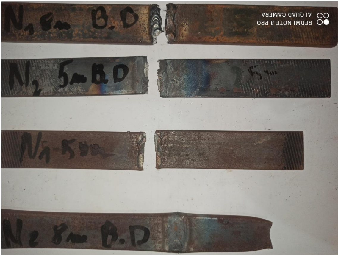
Figure (IV.11): éprouvettes 8mm et 5mm soudées par différents procédés de soudage après traction.
