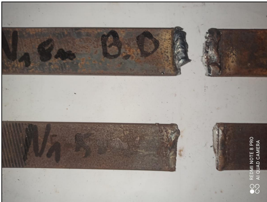
Figure (IV.03): Eprouvettes (5mm et 8mm) soudées par E.E après traction.
