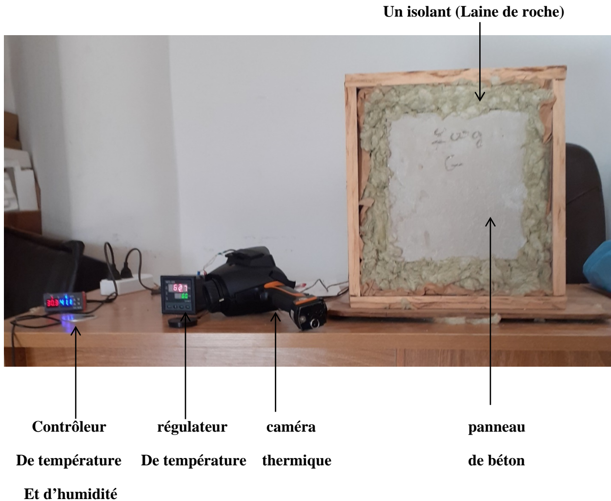
Figure III. 1 : Banc expérimental de l'isolation thermique.
