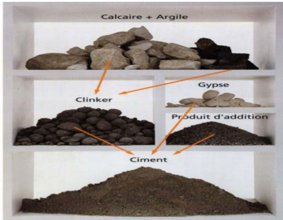
Figure II.3 : La description sommaire de de la fabrication du ciment.
