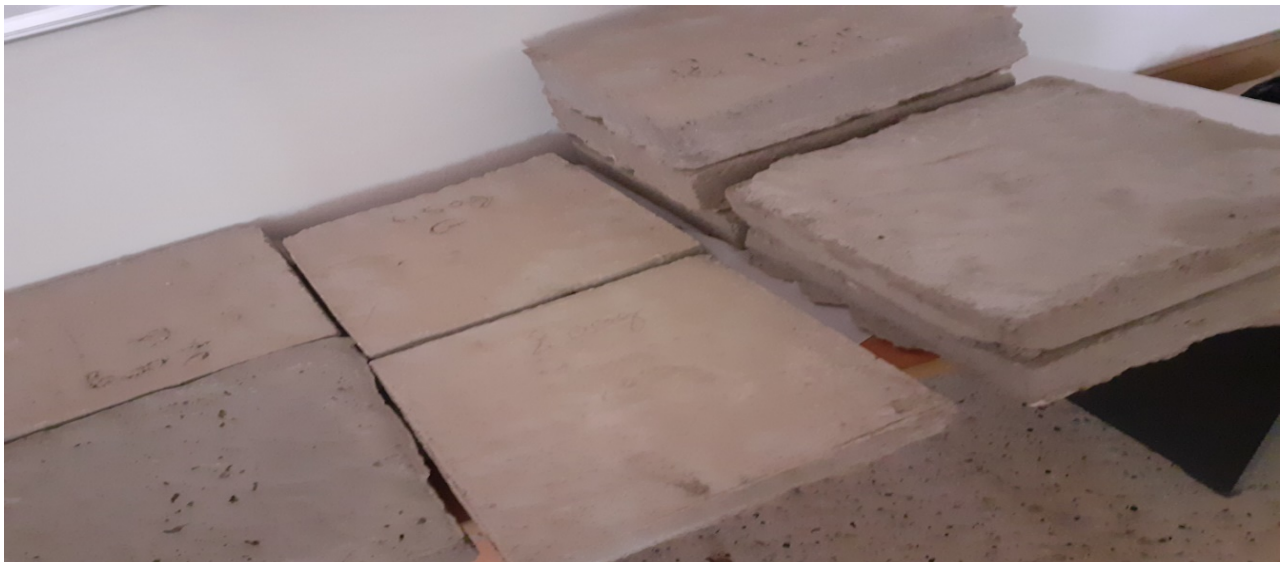
Figure III. 9: Les panneaux fabriqués en béton mélangé avec la diatomite.
