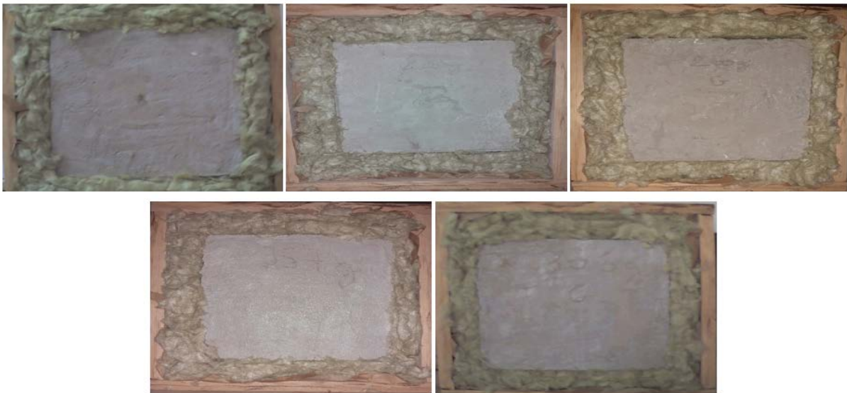
Figure III. 5: Les différents panneaux du béton : (a) béton ordinaire, (b) béton/diatomite (poudre 200g), (c) béton/diatomite (gravier 200g), (d) béton/diatomite (poudre 357g), (e) béton/ diatomite (gravier 306g).
