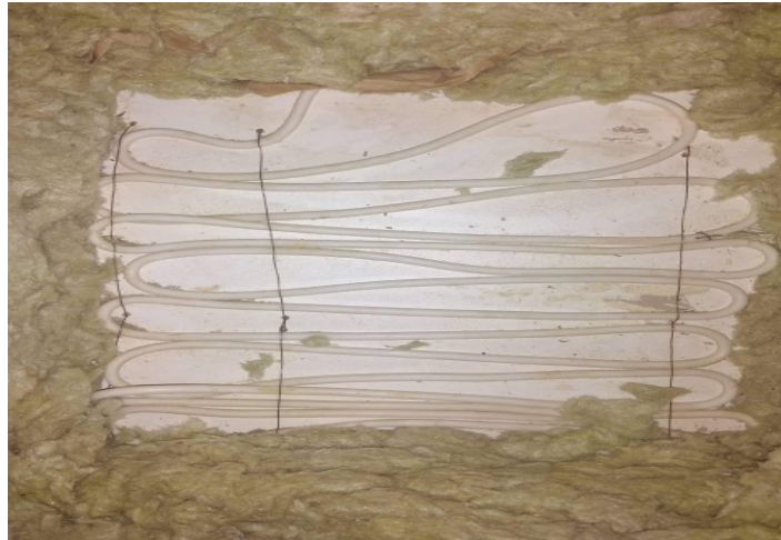
Figure III. 2 : La résistance thermique.
