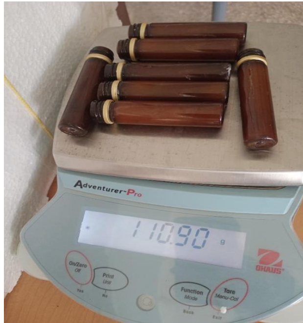
Fig. III.19 : Poids des capsules remplies de la paraffine
