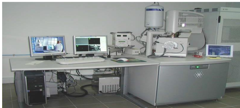
Figure III. 16: Microscope électronique à balayage (MEB)
