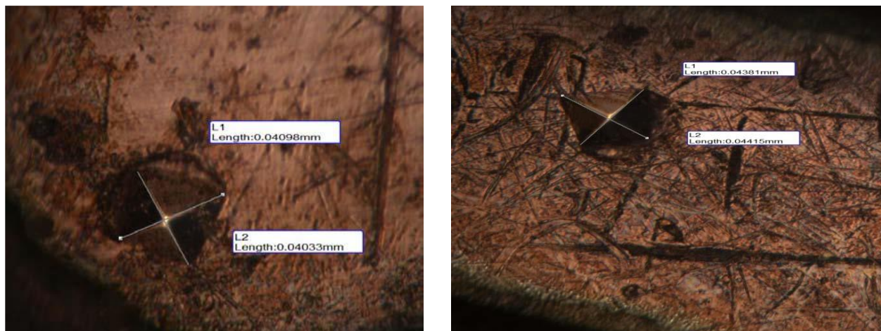
Figure III. 18: Empreintes du micro-duromètre observées sur l'échantillon
