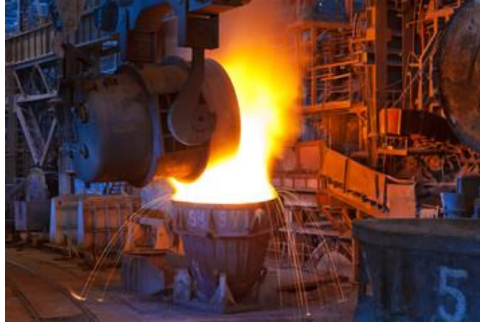
Figure II. 10: Convertisseur à l'oxygène [27]
