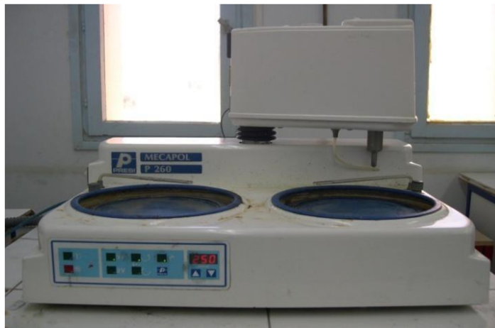
Figure III. 14 : Polisseuse mécanique de type PRESI MECAPOL P260
