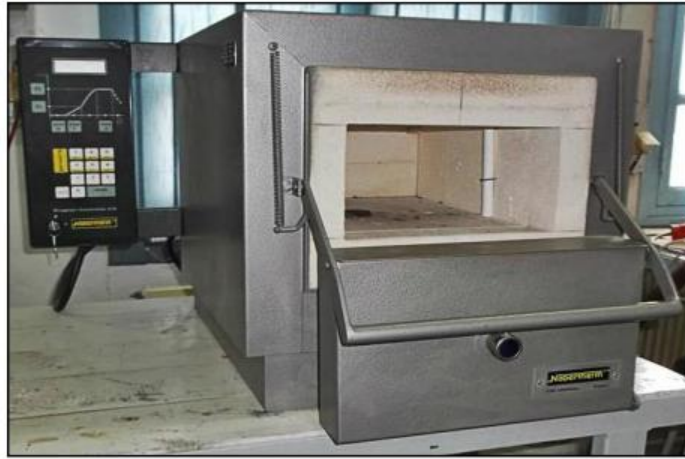
Figure I. 12 : Four de traitement thermique. [6]
