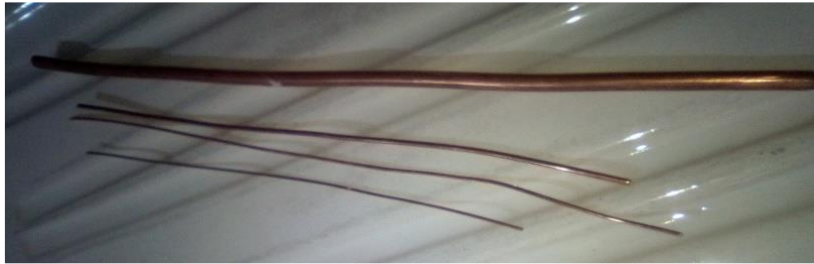
Figure III. 12: Fil machine et fils tréfilés de cuivre étudiés
