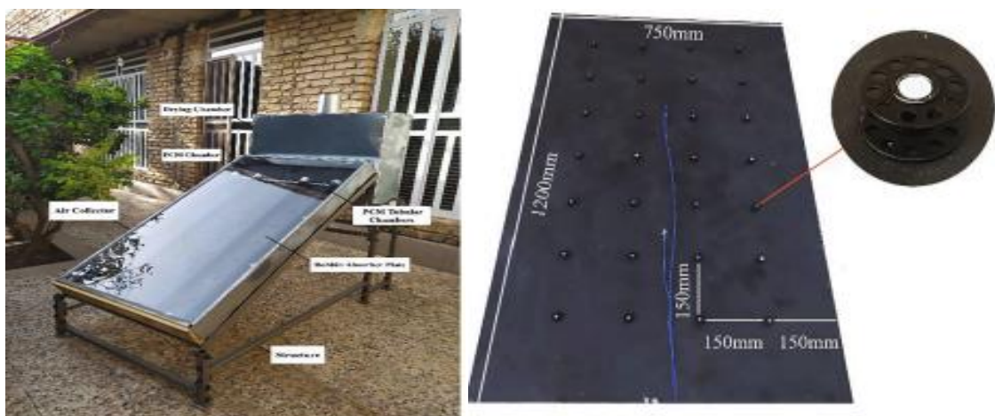
Figure II. 6 : Une vue du séchoir solaire et de la plaque d'absorption à bobine utilisées dans le collecteur.
