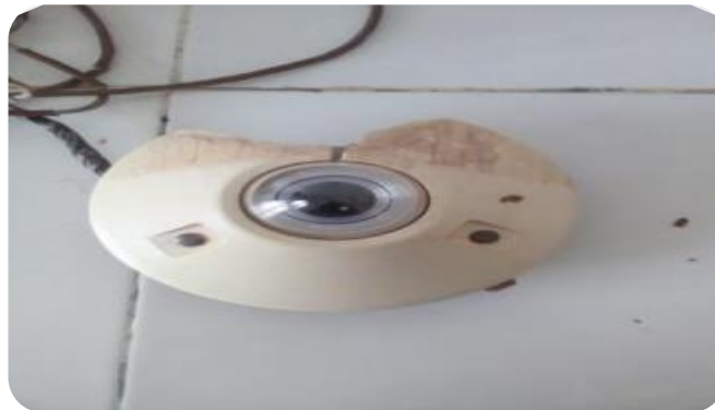
Figure III. 6: Pyranomètre Kipp et Zonen CM11.
