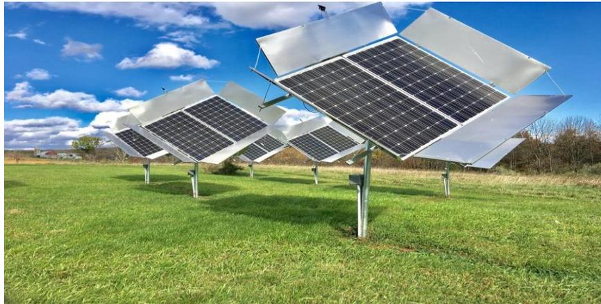
**Fig.II.34** : Panneaux photovoltaïques à réflecteur solaire. [97]
