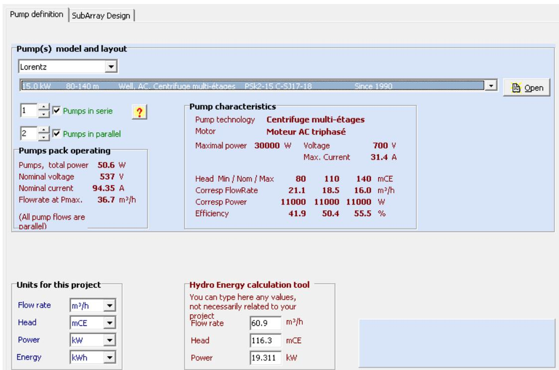
Fig.III.46 : Identification des caractéristiques de la pompe de l'installation du pompage solaire du forage vers le bassin 3.
