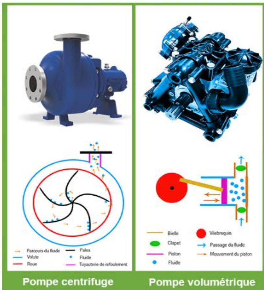
Fig.II.31 : Pompe centrifuge et pompe volumétrique. [79]
