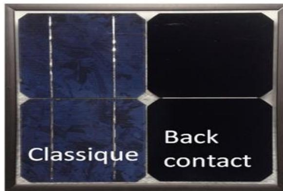
Fig.II.16 : Comparaison entre cellules classiques et cellules « Back contact ». [50]
