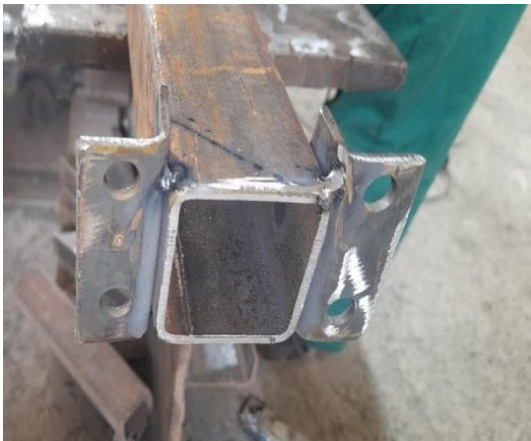
Figure 39 : Assemblage du tube carré avec platine en utilisant une équerre
