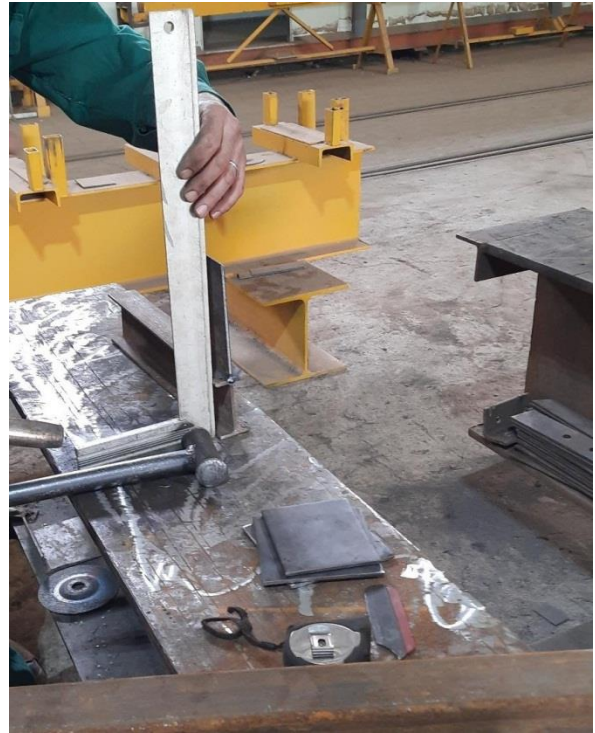
Figure 39 : Assemblage du tube carré avec platine en utilisant une équerre
