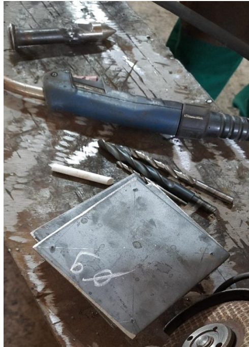
Figure 31 : Traçage des pièces pour perçage
