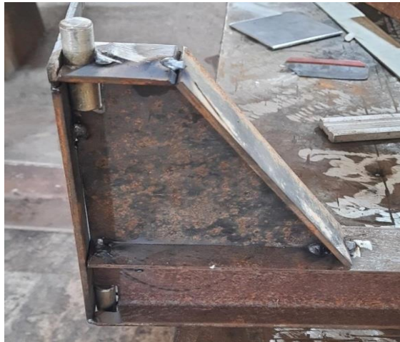
Figure 41 : Soudure des tôles avec l'IPE
