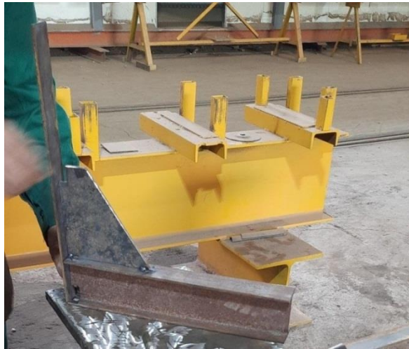
Figure 41 : Soudure des tôles avec l'IPE
