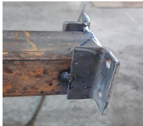
Figure 39 : Assemblage du tube carré avec platine en utilisant une équerre
