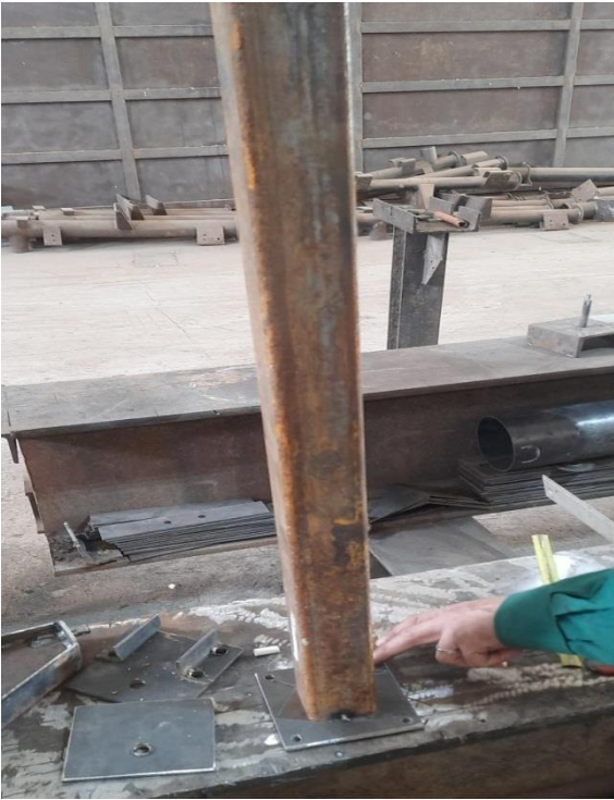
Figure 39 : Assemblage du tube carré avec platine en utilisant une équerre
