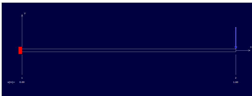
Figure 20: barre encadrée sollicitée à la flexion
