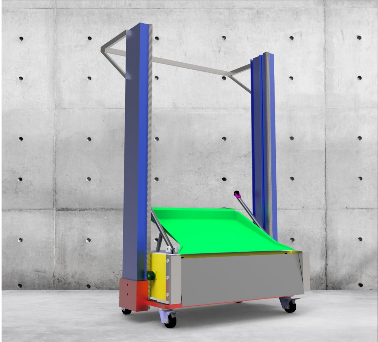
Figure 5-1 : Assemblage de la machine à plâtrer
