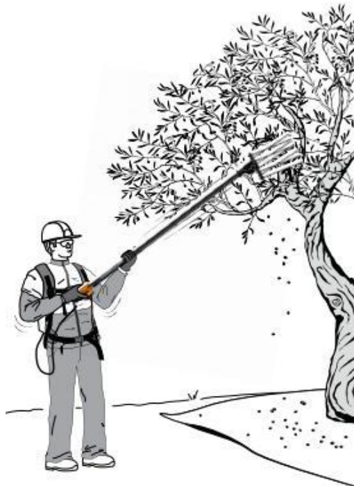
Figure 6: Vibreur de branches avec source d'énergie reliée au dos de l'opérateur
