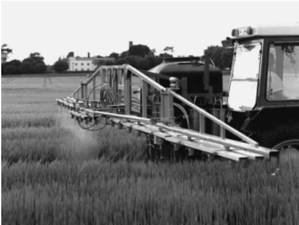
FIGURE 7 – Pulvérisateur d'herbicide à taux variable développé par Stafford et Miller (1993)
