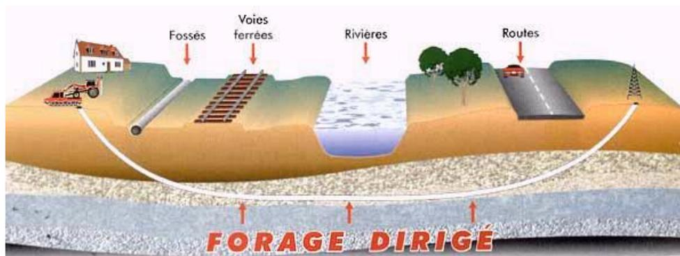
Figure 2.18 : Procédure utilisée pour le forage dirigé. [52].
