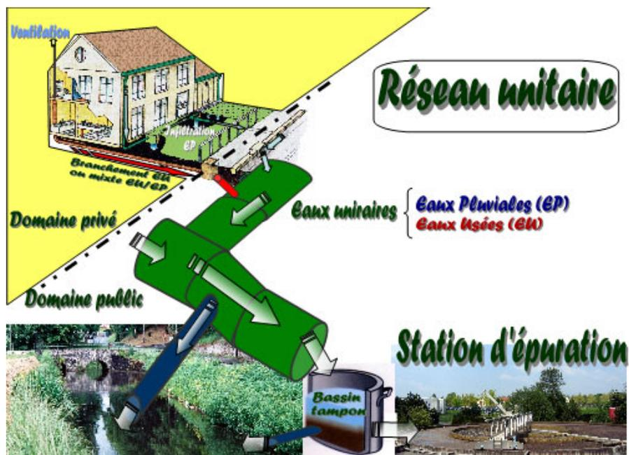
Figure 1.8 : Schéma d'un Réseau Unitaire. [16].
