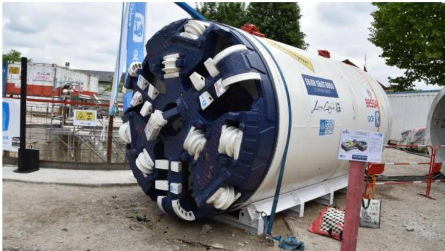
**Figure 2.17 :** Photo d'un micro tunnelier. [51].
