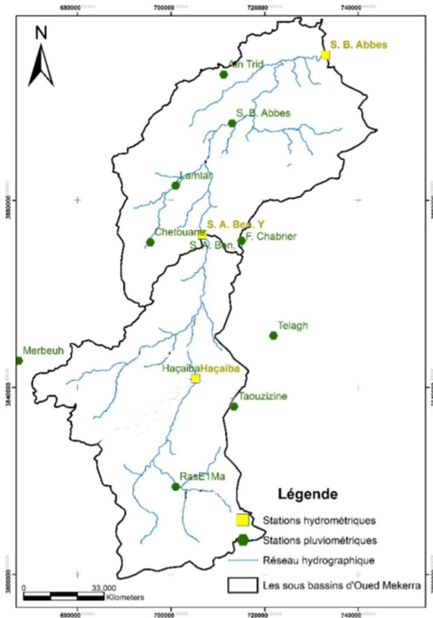
Figure 22 Localisation des stations hydro-pluviométriques au niveau du bassin de la Mekerra
