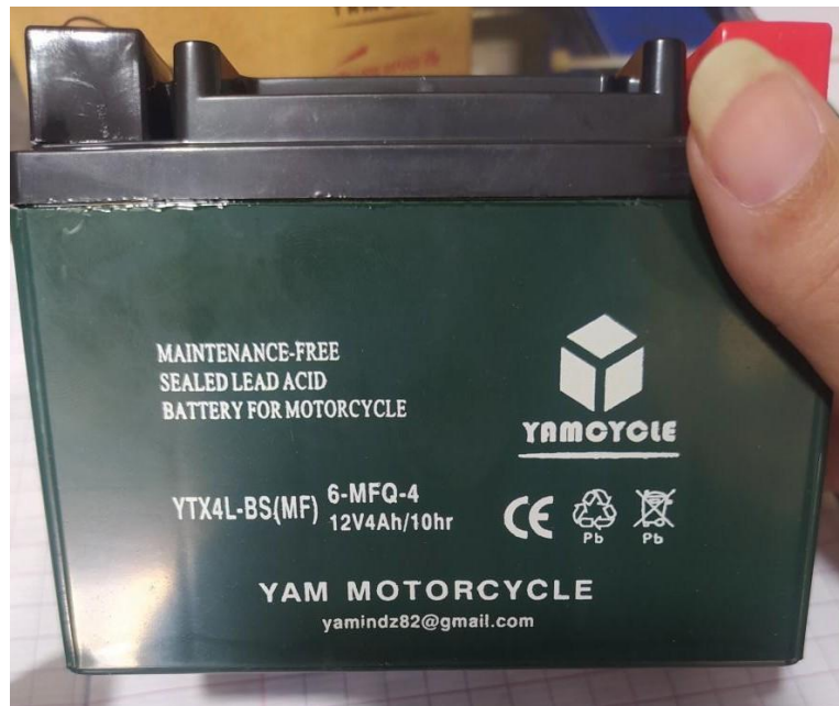
Figure.III.27 la batterie utilisée « 12V, 4A »
