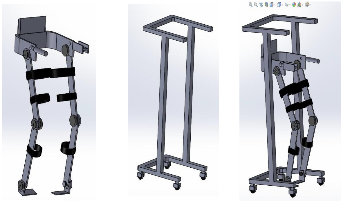
Figure .III.15. L'assemblage du model d'exosquelette avec le support mobile
