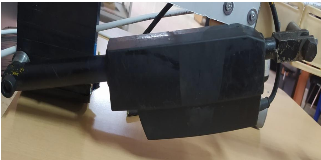
Figure.III.26 Vérin électrique pour articulation hanche : 12V, 1-14A
