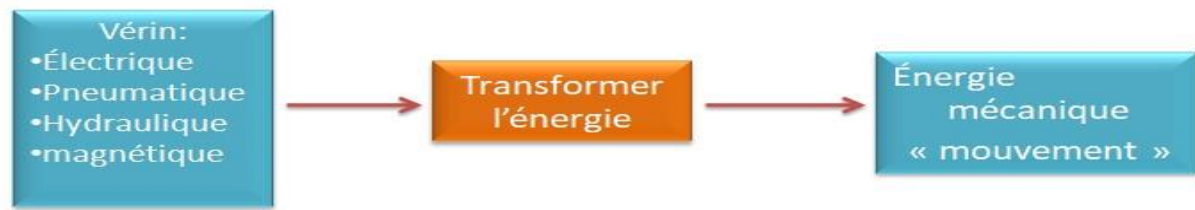
Figure.III.23. Schéma illustre le fonctionnement des vérins
