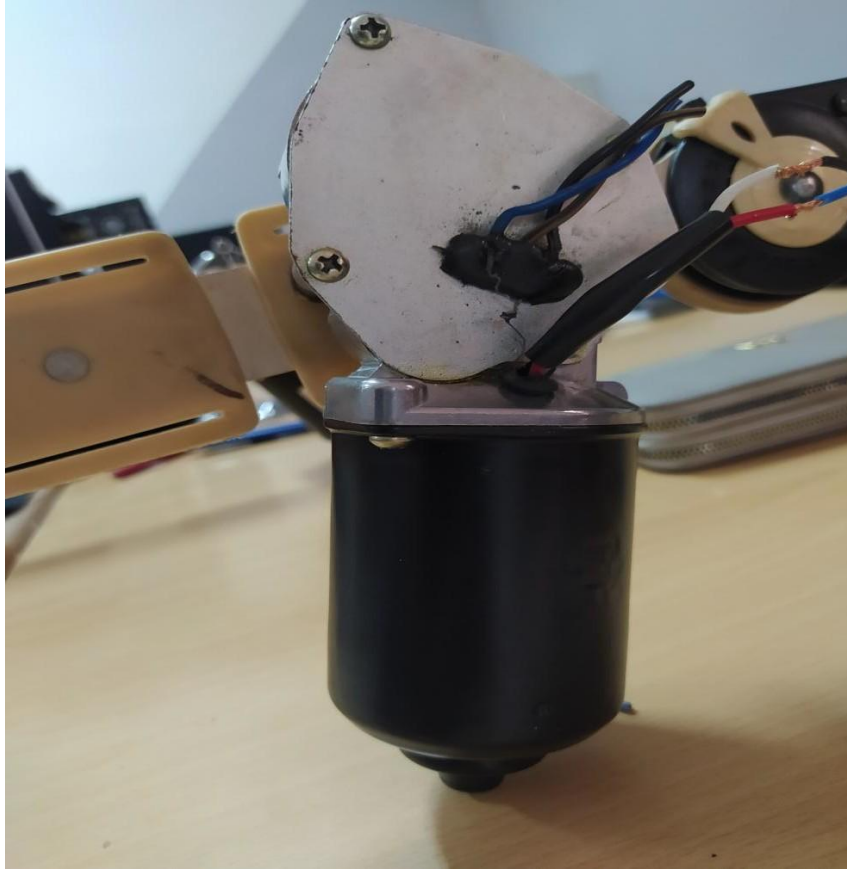
Figure.III.25 Moteur à courant continu avec réducteur pour l'articulation genou : « wiper motor » 12V, 50W
