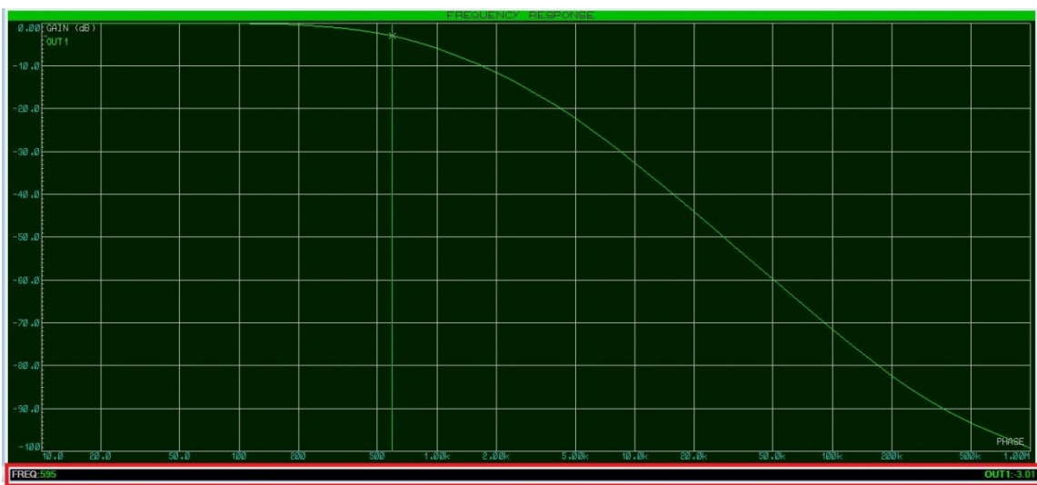
Figure 2.22 : Tracé de la réponse fréquentielle de filtre actif passe-bas structure RAUCH pour le signal EMG sous Proteus.
