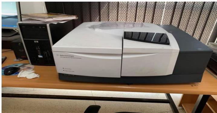
**Figure II.14** : Photo de spectromètre infrarouge FITR/NIR
