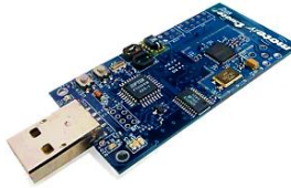
Figure 22. Plate-forme de nœuds de capteurs TMote Sky
