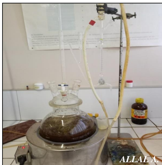
Figure 10 : Montage de l'hydrodistillation de type Clevenger
