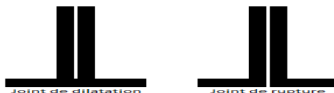
Figure 54 : coupe schématique des joints
