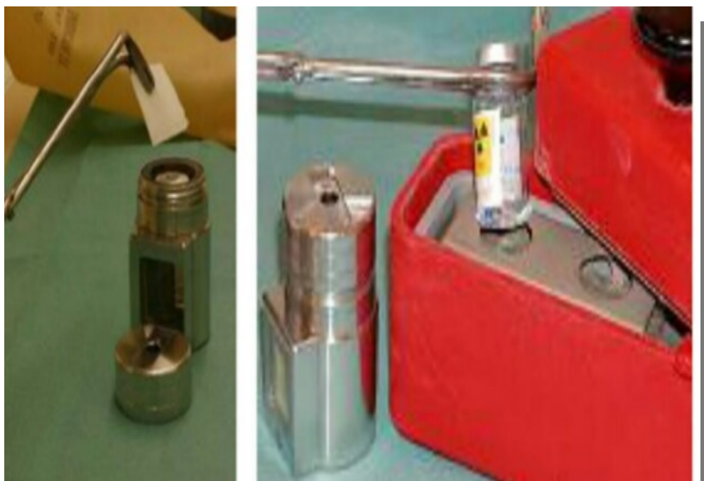
Figure 38: Pince de manipulation à distance.
