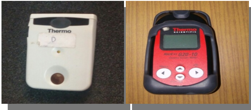
Figure 46: Dosimètre opérationnel et débitmètre
