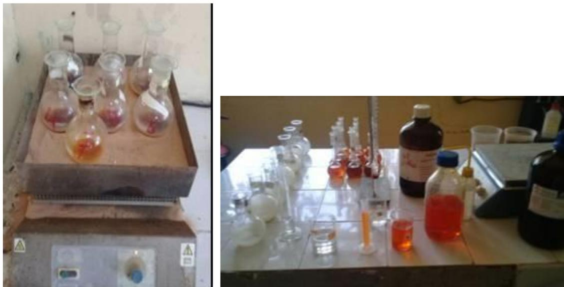
Figure 58: Détermination du carbone organique par oxydation sulfochromique
