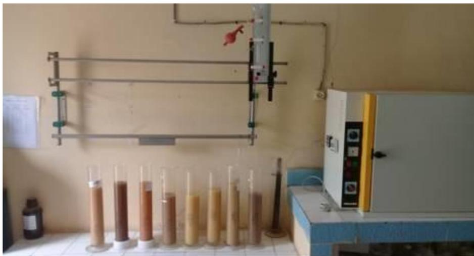
Figure 56: granulométrie par Pipette de Robinson
