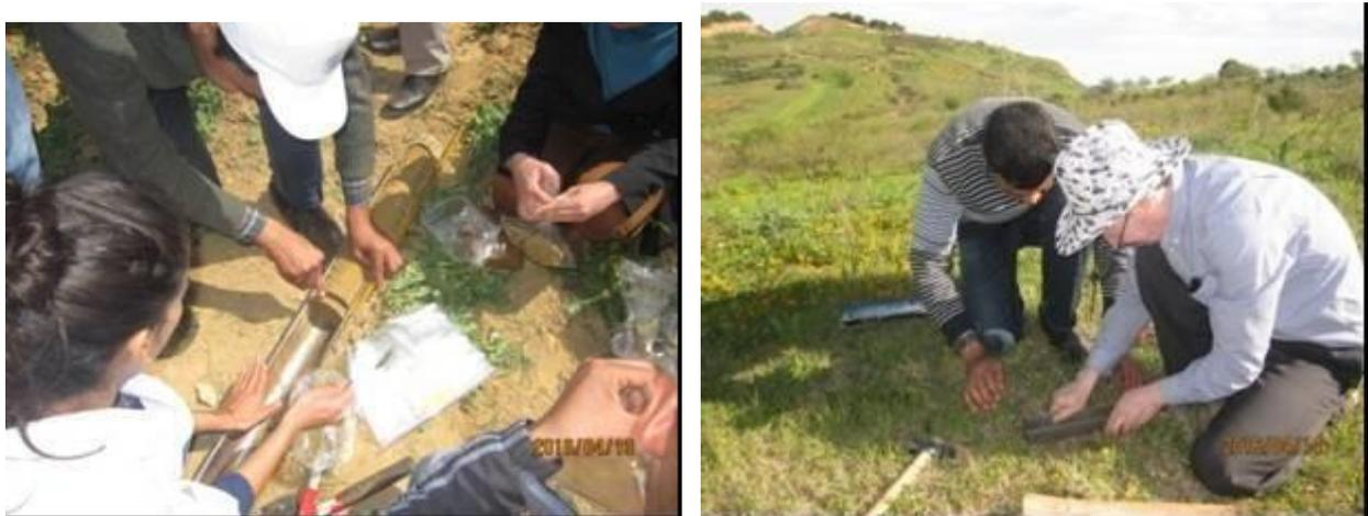
Figure 54: Cadran d'échantillonnage et Segmentation de la carotte.
