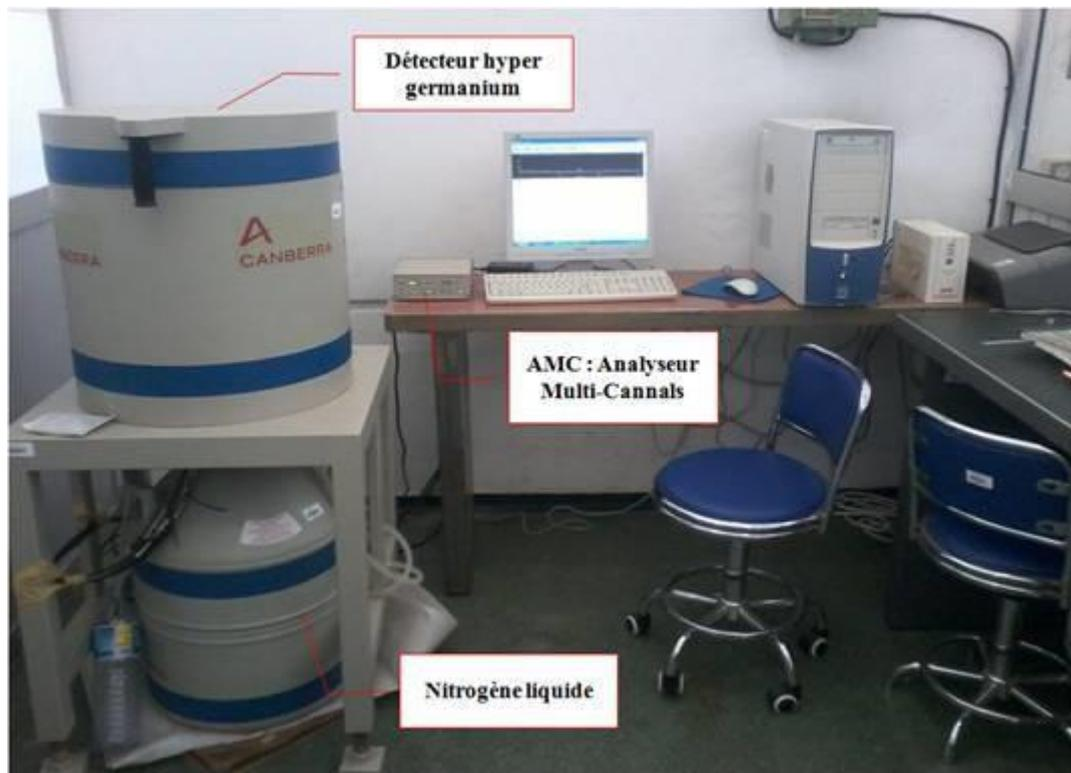
Figure 59: Chaîne de spectrométrie gamma utilisée dans cette étude.
