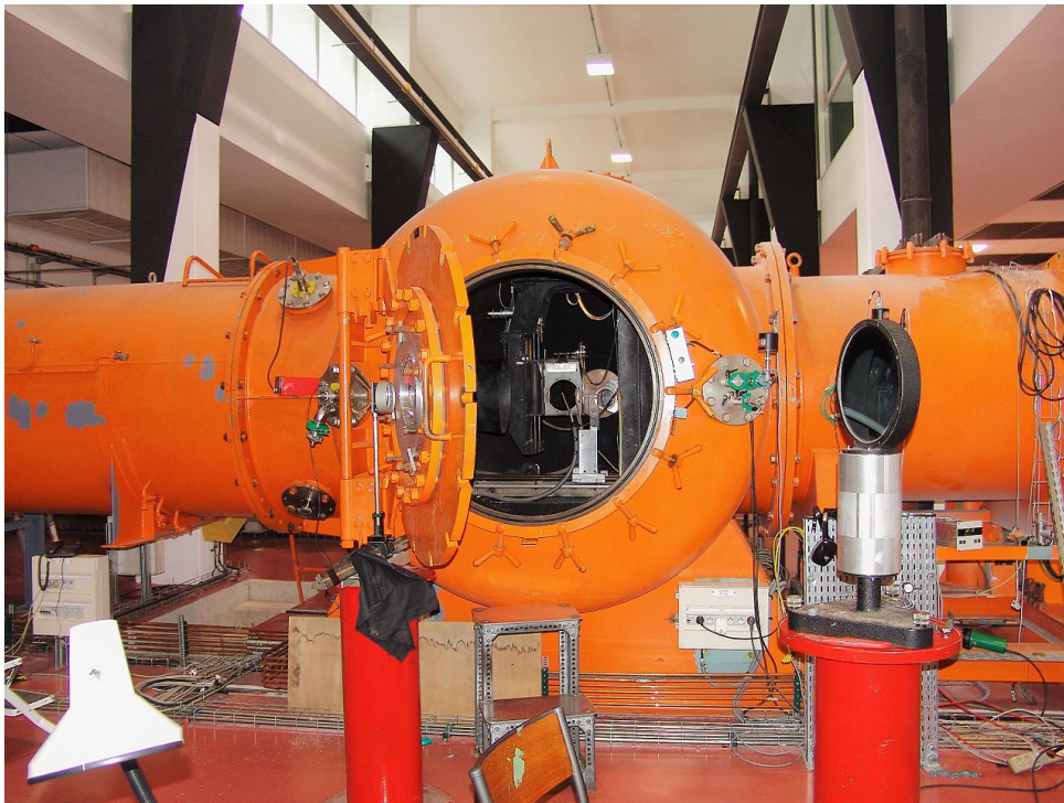
FIGURE 2.3 – L'environnement expérimental de la soufflerie MARHy [4]
