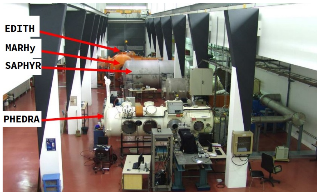
FIGURE 2.1 – Les souffleries de la plateforme expérimentale FAST [4]
