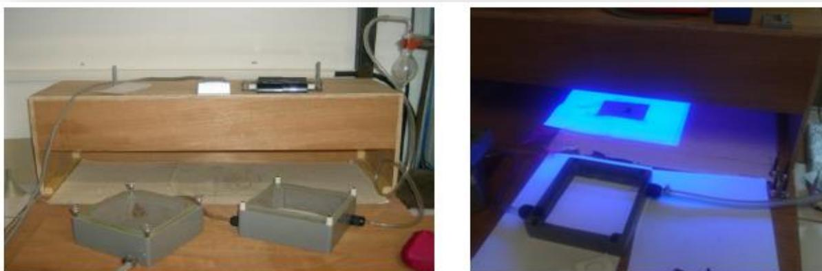
Figure II-7 : *Dispositif expérimental utilisé pour la polymérisation induite par le rayonnement UV, dispositif complet avec les deux lampes.*
