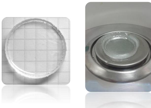
Figure II-8 : Photographie d'un réseau de PABu après sa polymérisation
