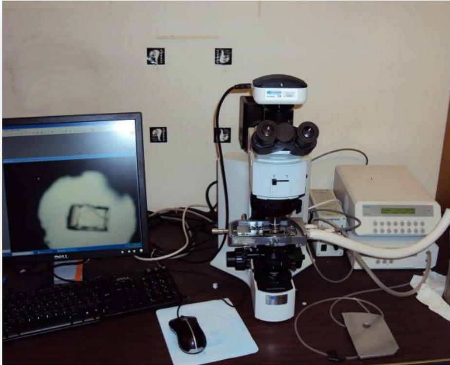
Figure II.21 : Microscope optique doté d'une cellule Linkam
