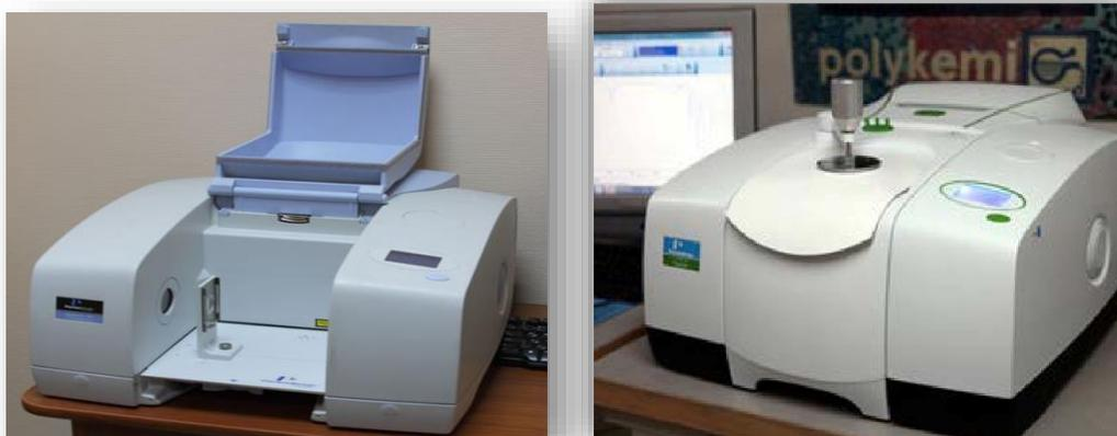
Figure II-9 : Dispositif FTIR-Frontier et ATR de type Perkin-Elmer.
